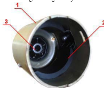
Rys. 3. Stojan (magneśnica) silnika: 1 – jarzmo, 2 – magnesy trwałe, 3 – tarcza łożyskowa
