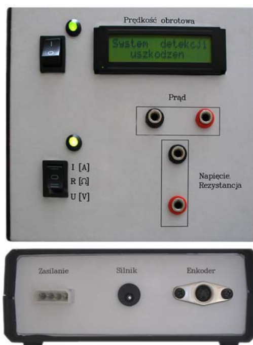
Rys. 10. Urządzenie do pomiaru prędkości obrotowej oraz wielkości elektrycznych
